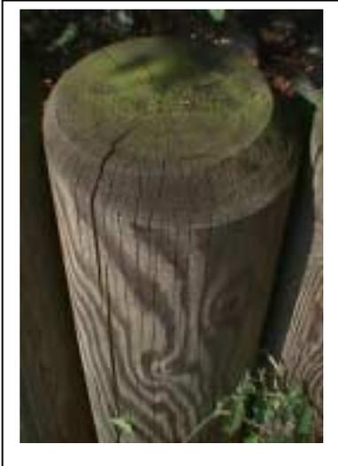
Rundgefräste Palisaden bei denen ein Teil des Splints oder der Splint vollständig abgefräst wurde neigen zur geringeren Rissbildung.
