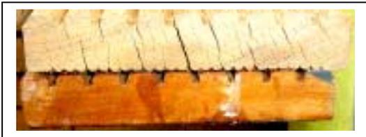
Bei der z.B. stark zur Rissbildung neigenden Holzart Bangkirai (siehe Bild) kann durch ein Versiegeln der Hirnholzfläche die Bildung von Endrisse minimiert werden.
